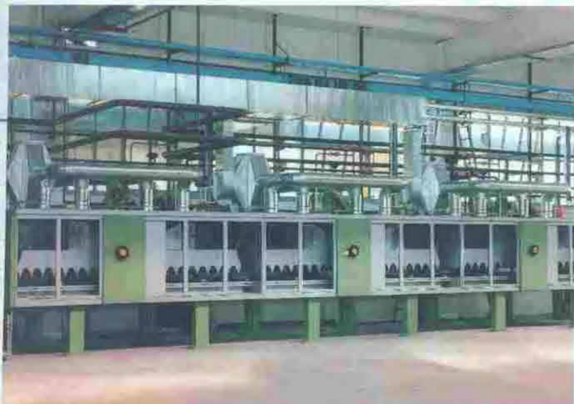
Termocanale di asciugamento a doppia ventilazione, con recuperatore di calore aria-aria.
